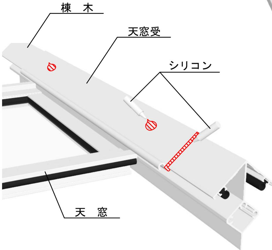
2. 天窓取付け後、天窓受を取付けたタッピンねじの頭をシーリングし、天窓受の両側にシーリングを塗布してください。
